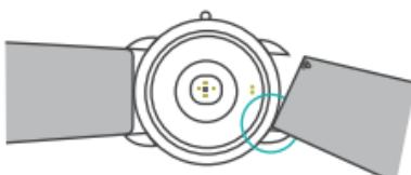
②クイックリリース レバーを内側に押しながら、リストバンドの反対側の端を所定の位置に置きます。
